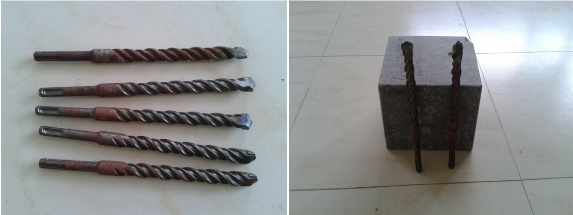
Fig. 6.2 Tungsten carbide drill bits
